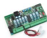
Плата блока управления (многофункциональная) с автоматическим тестированием устройств безопасности и разъемом для установки радиоприемника CAME
